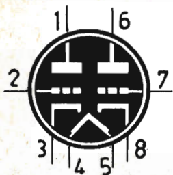
6BZ7 DOPPIO TRIODO AMPL. VHF (zoccolo noval)
